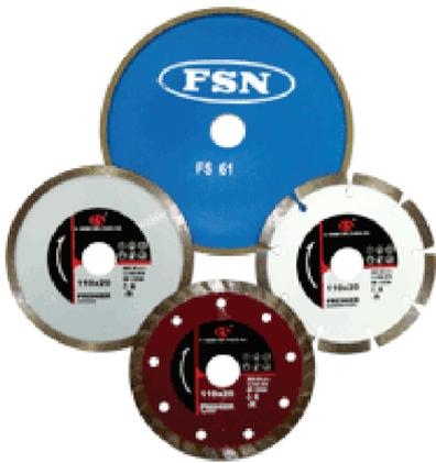
Engloba um conjunto de discos diamantados utilizados em máquinas portáteis manuais, com banda contínua ou segmentada, podendo ser utilizados com refrigeração ou em cortes a seco.
